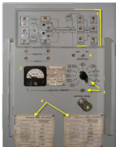
Рис. 45. Верхняя часть передней панели стойки 1500: 1 – упрощенная трактовая мнемосхема; 2 – контроль режимов; 3 – переключатель и тумблер прибора; 4 – тумблер включения автоматики; 5 – ВЧ разъем для измерения уровня видеосигналов на входе приборов МД-О и МД-Р
