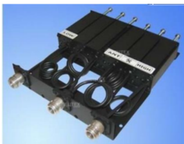
Рис. 74. Мобильный дуплексер MDF1-6VH4.5/6
