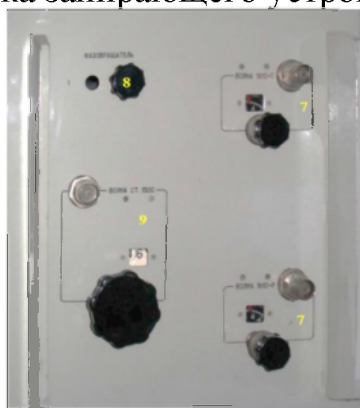
Рис. 46. Нижняя часть передней панели стойки 1500: 7 – ручки перестройки приборов и ВЧ разъемы; 8 – ручка фазовращателя; 9 – окно прибора 1560, ручка перестройки прибора и ВЧ разъем «ВОЛНА 1500»
